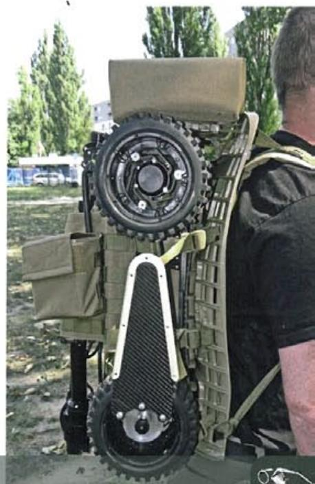
Dodatkowe wyposażenie **PIAP Fenixa** mogą stanowić np.: zestaw czujników CBRN, głowice obserwacyjne z kamerami nokto- i termowizyjnymi, mikrofony kierunkowe, dodatkowe oświetlaczki czy detektory różnego typu (np. materiałów wybuchowych). Użytkownik może także zamówić zapasowe akumulatory, ładowarki i plecak do transportu robota.
